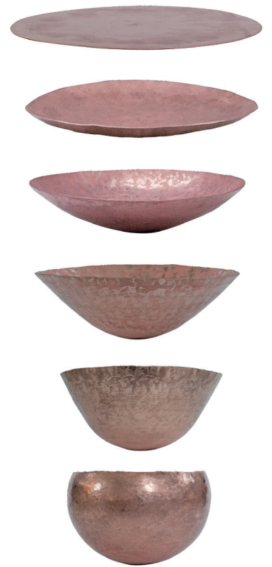
【圖2】鍛敲收縮漸進圖（由上而下）從最上方一片金屬圓片開始，邊緣漸升起，隨鍛敲過程的演進，立體造型愈發明顯
