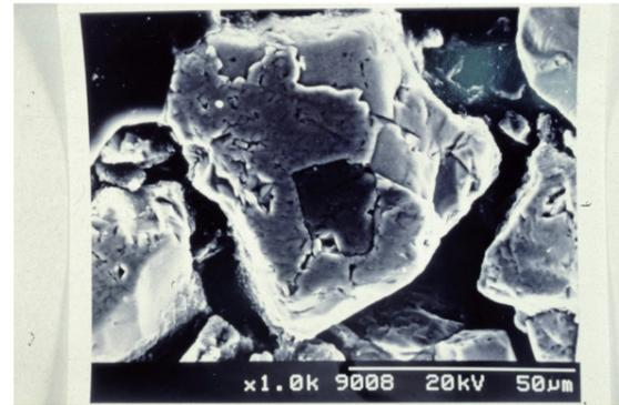
【圖 2】黃鐵礦可經由吸附、包裹、晶格取代等方式而保留各礦化時期化學環境之線索，為地球化學探勘之優良工具。圖中黃鐵礦的電子顯微鏡照片顯示其包含有其他礦物的包裹體。
