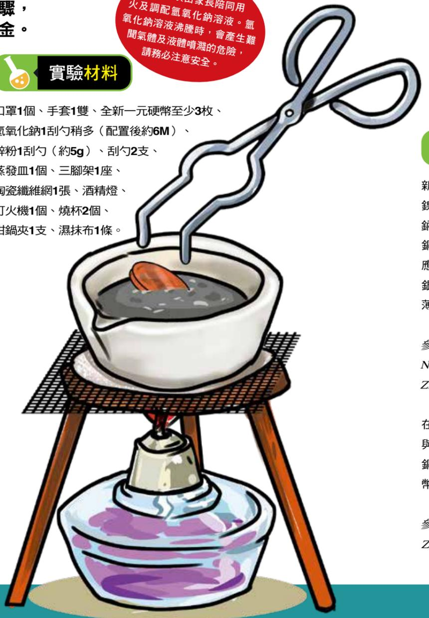
5. 以坩鍋夾取出硬幣，放入裝有水的燒杯，再用紙巾或抹布擦乾硬幣，但切勿搓磨硬幣的表面，此時會發現銅幣變成「銀幣」。（圖B）
