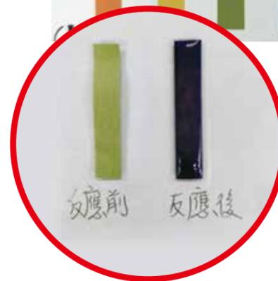
← 燃燒完畢，廣用試紙檢驗滴瓶內的物質的酸鹼性，廣用試紙呈藍紫色，代表物質呈鹼性 $(\text{Ca(OH)}_2)$ 。
