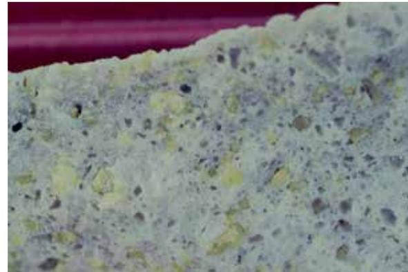
圖 14 生長於矽化安山岩溶蝕的孔洞內的自然硫結晶（本樣品來自萬里石洞山）。
