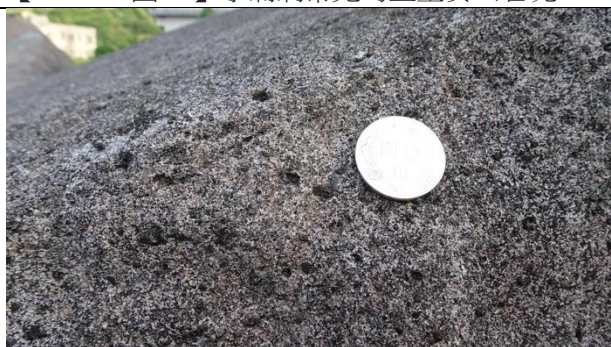
【DH-S02-圖 19】巨型安山岩塊有黑色斑晶，表面呈現長期風化後的淡粉紅色
