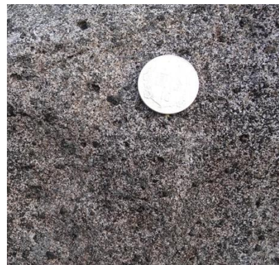
【圖 19】基隆山大型落石局部 此為圖 18 之小尺度圖像，可以觀察到岩石表面呈現淡粉紅色和分佈許多細小孔洞，此為安山岩經風化作用後的特徵
