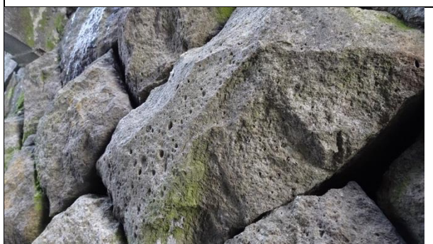
【DH-S01-圖 7】石材呈灰色，表面孔洞為石英黑雲母角閃石安山岩經長期風化之特徵
