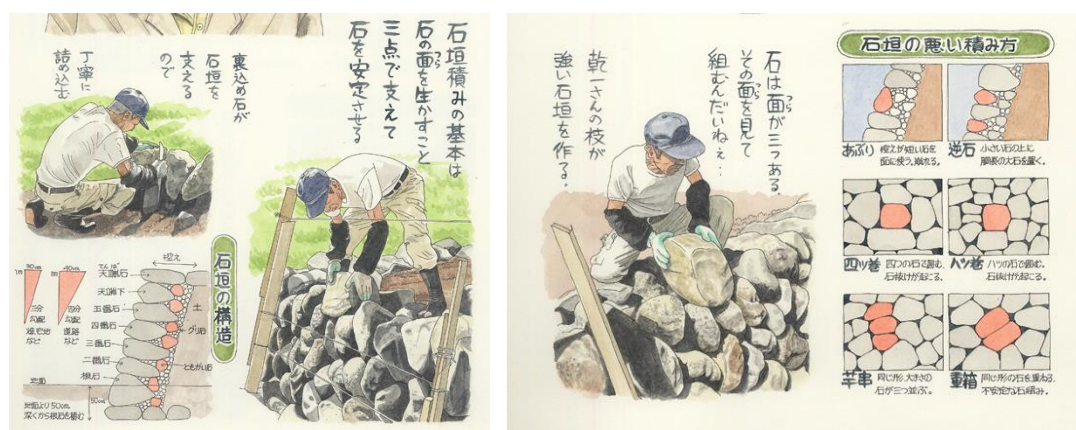
【圖 56】以插畫解說砌石工法示意
