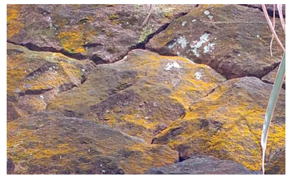
【DH-K01-圖 7】石塊外觀破裂略呈貝殼狀，推測受到輕度矽化作用
